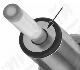
Figure 5 : Interstice avec joint torique
