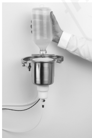
Figure 7 : Mise en place de la bouteille d'électrolyte
