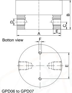
Type ΑΦ В С D Е GPD01 72 21 10.5 M12×1.5 14 GPD01/1 72 21 M12×1.5 10.5 14 GPD01/2 72 30 10.5 M12×1.5 14 GPD02/1 80.5 26 12 M12×1.5 14 GPD02 80.5 30 M12×1.5 12 14 GPD03 80.5 42 12 M12×1.5 14 GPD04 34 17 121 M20×1.5 18 GPD05 170 45 22.5  $M33 \times 2$ 18
